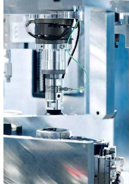
*Solution verticale de mesure de force de pression avec capteur de force piézoélectrique de type 9311*
